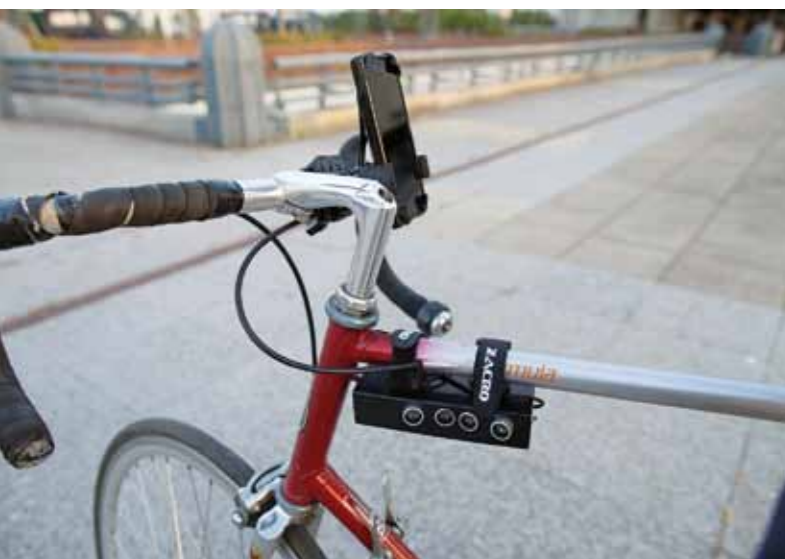
Der Radmesser im Einsatz: Ultraschallsensoren messen den Überholabstand und senden die Daten direkt ans Smartphone.
