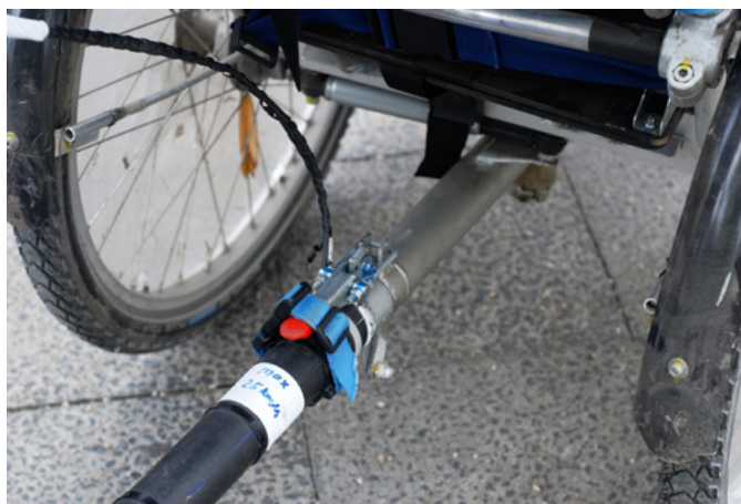
Dank der selbstgebauten Kupplung kann der Rollstuhl vom Fahrrad gelöst und eigenständig verwendet werden.
