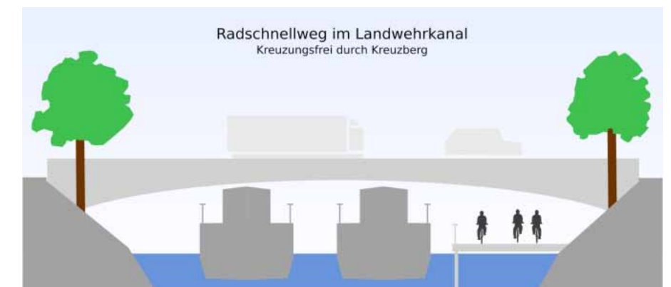
Abb. 2: Kreuzungsfreie Radschnellroute im Landwehrkanal, ein Steg macht's möglich. (Abb. Philipp Poll)
