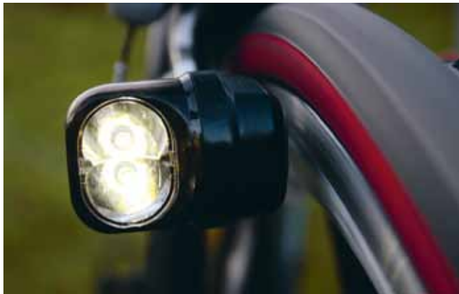
Einleuchtend: Der Magnic Light Felgendynamo funktioniert berührungslos. Aus der rotierenden Felge wird auf Wirbelstrombasis mit Neodym Magneten Strom erzeugt – Kabel und Batterien waren gestern.
