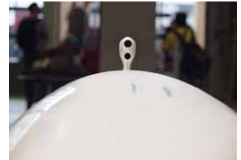
Stielauge, sei wachsam. Im Rad für den aktuellen Rekordversuch ersetzt eine Kamera die Frontscheibe.
