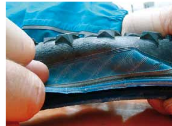
Alterungsrisse im Profil und Risse an der Flanke wegen zu geringen Luftdrucks.
