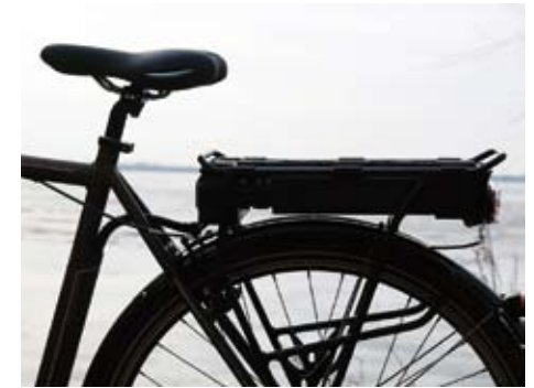
Kraftpakete: Äußerlich gibt sich das Pedelec hauptsächlich durch den Motor in der Vorderradnabe und das Akkufach unter dem Gepäckträger zu erkennen.
