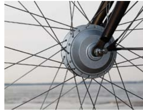
Kraftpakete: Äußerlich gibt sich das Pedelec hauptsächlich durch den Motor in der Vorderradnabe und das Akkufach unter dem Gepäckträger zu erkennen.
