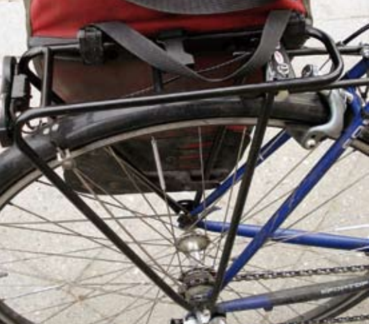
Typischer Stahlrohrgepäckträger: maximale Zuladung 25 Kilogramm.
