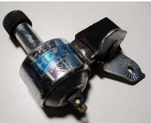
Auf dem Abrollgleis: der Seitenläufer-Dynamo. Fotos: David Greve
