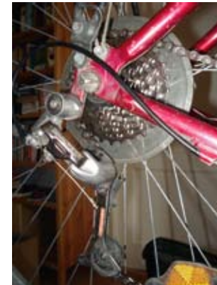
Viele Zähne: Ritzel und Schaltwerk.
